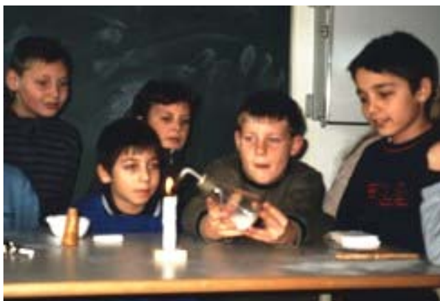
Abbildung 11: Der Wachsdampf wird gesammelt und fließt in den Erlenmeyerkolben.
