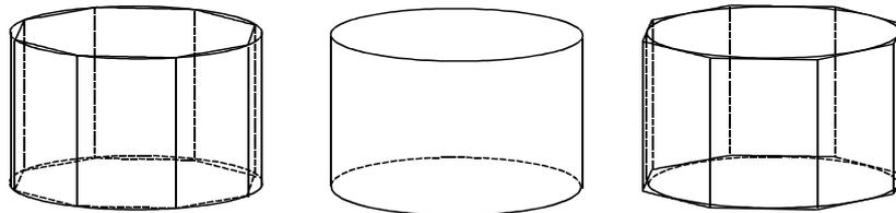
Wickeln wir den Mantel von einbeschriebenem und umschriebenem Prisma ab, so erhalten wir eine Einschachtelung für den Zylindermantel  $M_z$ .
